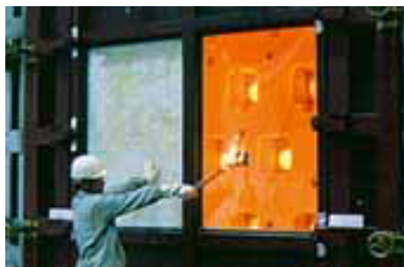
図5-1 防耐火試験加熱後45分過ぎの状態 パイロストップ(左)は加熱開始後白濁し遮熱性能を発揮して手で触れることもできるが、一般の防火ガラス(右)は前に立つこともできず、可燃物を近づけると着火する。
