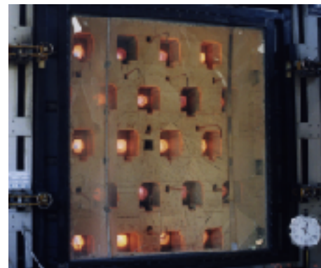
図5-3 網入板ガラス 加熱20分後
