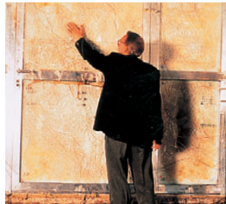
防火テスト中:パイロストップの非加熱面の温度は手でも触れられる程度の温度にしか上昇しません
